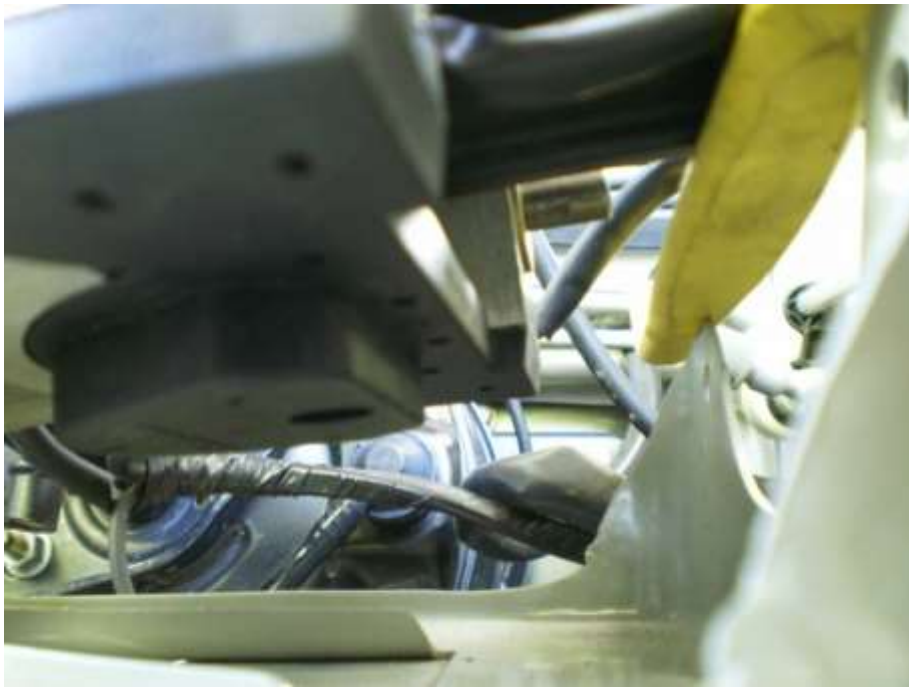
26. Reposition the PAS Fluid reservoir.
